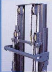
Der TRIPLEX Ständer mit Profilen aus speziellem Stahl und seitlichen Doppelkolben gewährt mit Hilfe des Staplers für den üblichen Materialhub bei großen Höhen optimale Leistungen, und eine einwandfreie Übersicht der Gabelfläche und daher einen einfachen Palettengriff.
