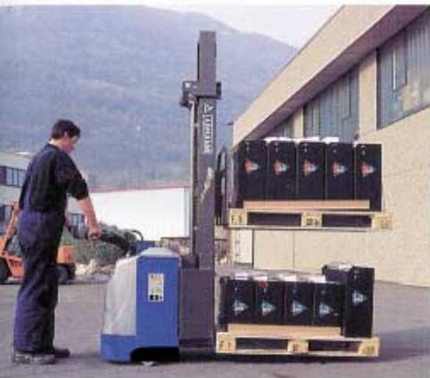
Der hydraulische Hub der Abstellbeine ermöglicht einen einfachen Überstieg der Rampen und der Bodenunebenheiten, der Stapler kann für den gleichzeitigen Transport zweier Paletten zum Einsatz gebracht werden.
